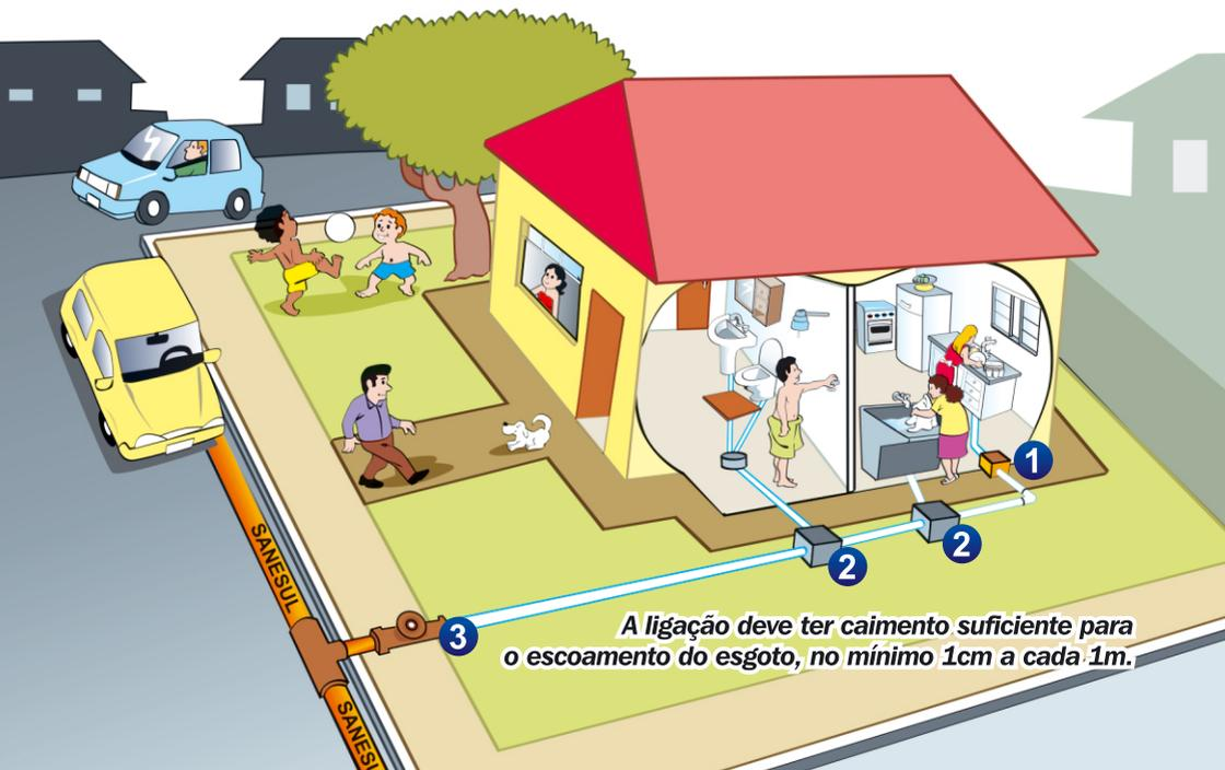
A ligação deve ter caimento suficiente para o escoamento do esgoto, no mínimo 1cm a cada 1m.
